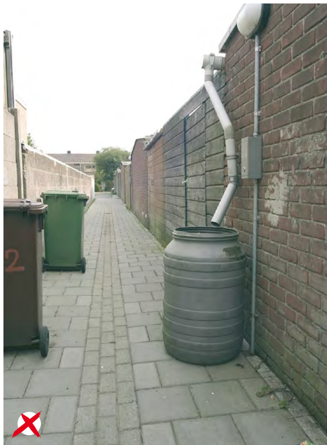
Fout: obstakels moeten worden verwijderd. De onderlinge afstand tussen de lichtpunten bedraagt maximaal zes keer de lichtpunthoogte.
