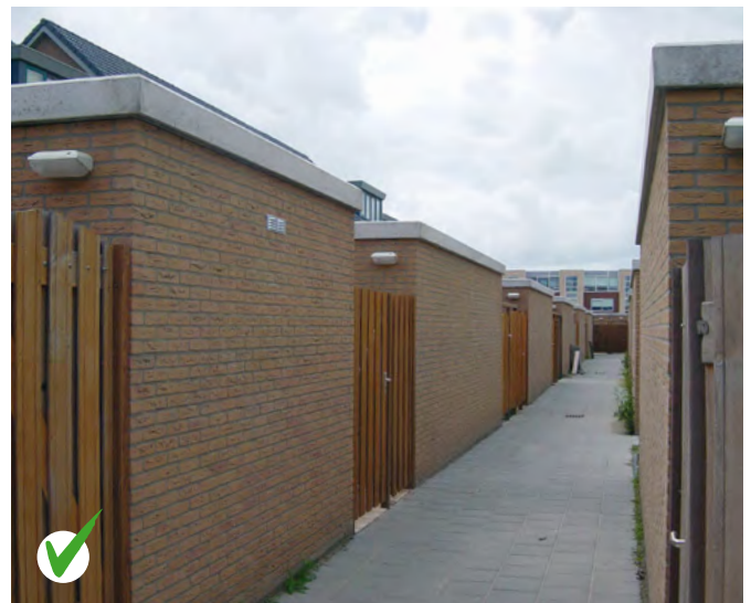
Hier is sprake van verlichting binnen dertig centimeter van de erfgrans en een maximale onderlinge afstand van twaalf meter.
