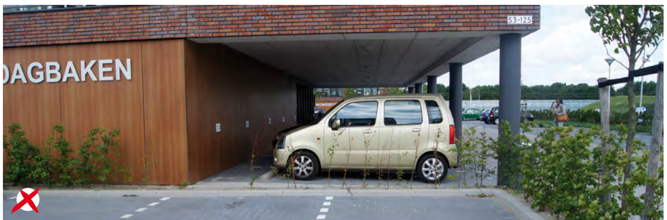
Fout. Parkeren in de plint van een gebouw wordt steeds vaker toegepast. Ook hierop dient zicht te zijn vanuit minimaal twee woningen.
